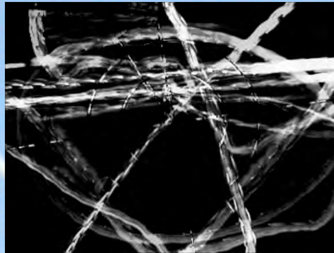
Spurenerzeugung durch ein Differenzbildverfahren
