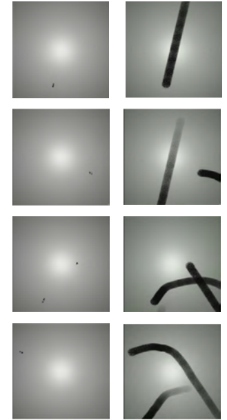
Skizze zur Erzeugung von Spuren (rechts) aus einer Bildfolge (links)
